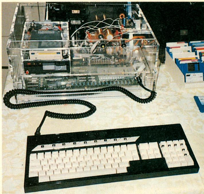
Jürgen Fiedler aus Neuss setzt auf Design und Durchblick und verfrachtete seinen 520 ST+ in ein Acrylglasgehäuse. Die Konstruktion war schon auf diversen Messen als Blickfang vorgesehen.
