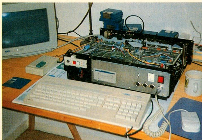
Thomas Wilhelmi aus Recklinghausen setzt ebenfalls auf Conrad Elektronik, da sich Laufwerkseinschübe ohne große Änderungen nutzen lassen. Den Turbo-Schalter hat er zur Monitorumschaltung umfunktioniert.
