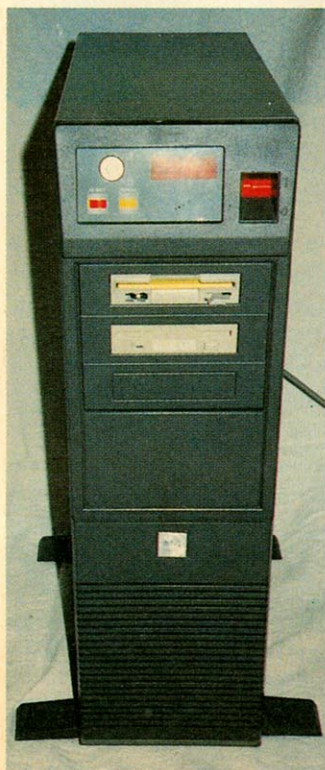
Dieter Ross verpflanzte seinen 1040er in einen geräumigen Tower. Die Platine ist leicht zugänglich und läßt sich an Möbelscharnieren herunterklappen. Als Stromaggregat dient ein 200-W-Baby-AT-Netzteil. Tower und Netzteil kosteten 300 Mark.
