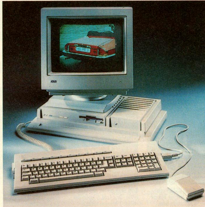
Mega STE: läuft mit einer Taktfrequenz von 8 oder 16 MHz
